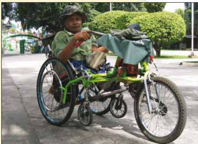
Ook deze gemotoriseerde rolstoel is gemaakt in de eigen werkplaats.
